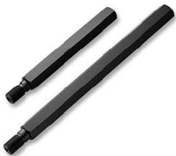
Предназначен для увеличения глубины бурения. Для тех случаев, когда необходимо пробурить отверстие, глубина которого превышает длину алмазной коронки. Удлинитель изготовлен из инструментальной стали 45. Снижения массы облегченного удлинителя удалось достичь за счет увеличенного диаметра внутреннего отверстия, а также благодаря проточке наружной поверхности.
