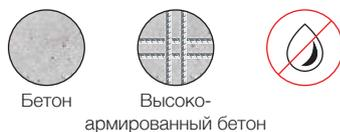
Предназначена для сверления высокоармированного бетона БЕЗ ВОДЫ как в режиме обычного сверления так и с микроударом. Лазерная сварка сегментов. Использовать перфораторы для сверления коронками Diamond Hit запрещено.
